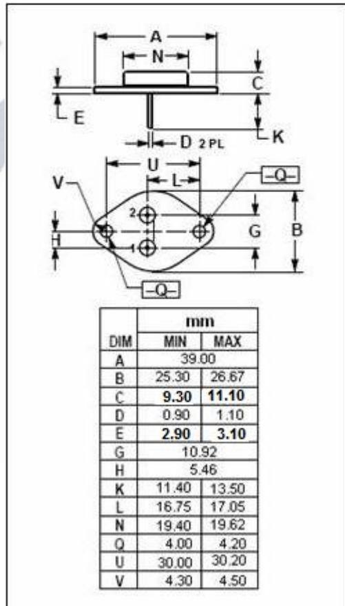
**isc Silicon NPN Power Transistor****2SD299****ELECTRICAL CHARACTERISTICS** $T_C=25^\circ\text{C}$  unless otherwise specified
