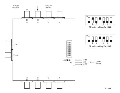
Figure 12. SKY42054 Evaluation Board LNA Testing Configuration
