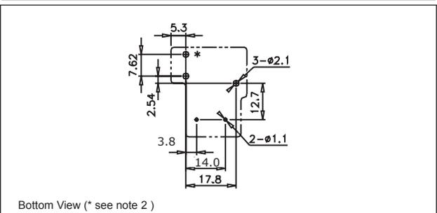
PCB Wiring Diagrams Fig. 3
