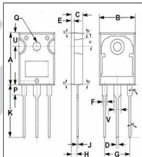
**isc N-Channel MOSFET Transistor****IRFP150M, IIRFP150M****ELECTRICAL CHARACTERISTICS** $T_c=25^\circ\text{C}$  unless otherwise specified
