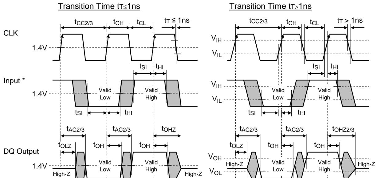
Note : The object of input are CKE, A0 to A11 /CS, /RAS, /CAS, /WE, UDQM to LDQM and DQ0 to DQ15 (input).
