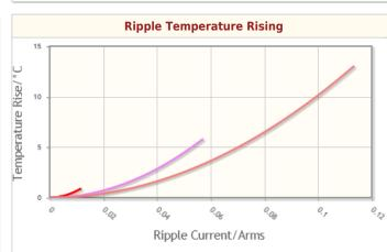
C0603X5R1E222K030BA(100kHz) C0603X5R1E222K030BA(500kHz) C0603X5R1E222K030BA(1MHz)
