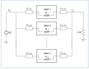
**Figure 21** — NBM module array
