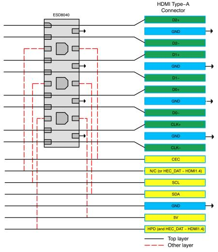
Figure 12. HDMI Layout Diagram
