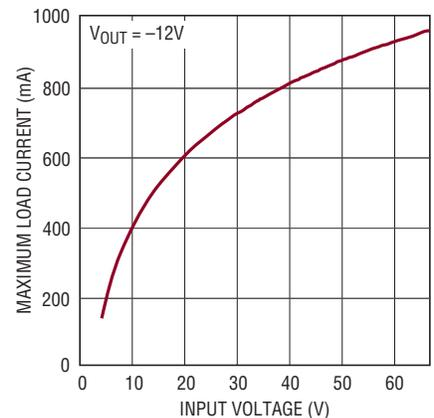
$$\text{MAXIMUM LOAD CURRENT} \approx \frac{V_{IN}}{V_{IN} + |V_{OUT}|} \cdot \frac{I_{PEAK}}{2}$$
