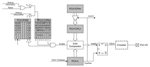
Figure 29.8. PCA1 8-Bit PWM Mode Diagram
