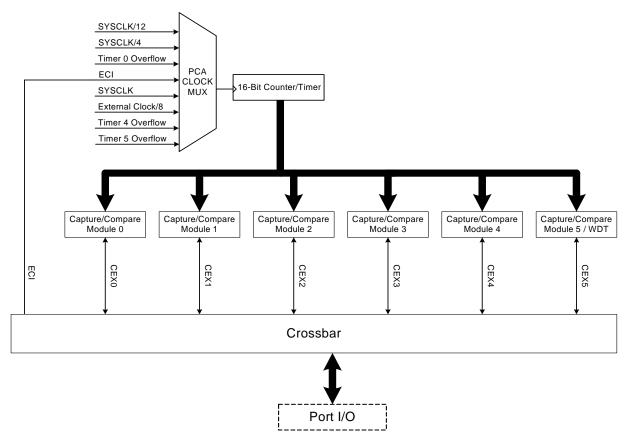
Figure 28.1. PCA0 Block Diagram
