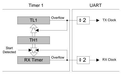
Figure 25.2. UART1 Baud Rate Logic
