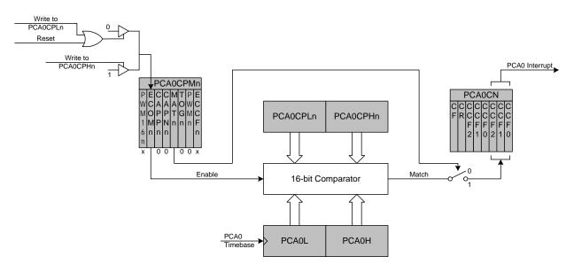
Figure 28.5. PCA0 Software Timer Mode Diagram
