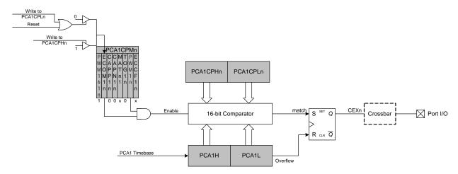
Figure 29.10. PCA1 16-Bit PWM Mode
