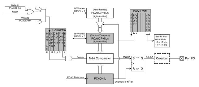
Figure 28.9. PCA0 9, 10 and 11-Bit PWM Mode Diagram
