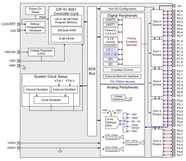
Figure 1.1. C8051F580/1/4/5 Block Diagram
