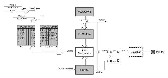
Figure 28.8. PCA0 8-Bit PWM Mode Diagram
