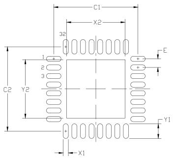
Figure 4.10. QFN-32 Package Drawing
