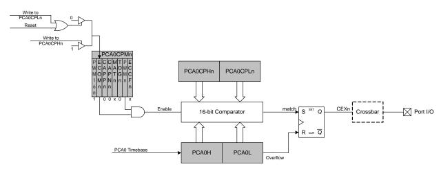
Figure 28.10. PCA0 16-Bit PWM Mode
