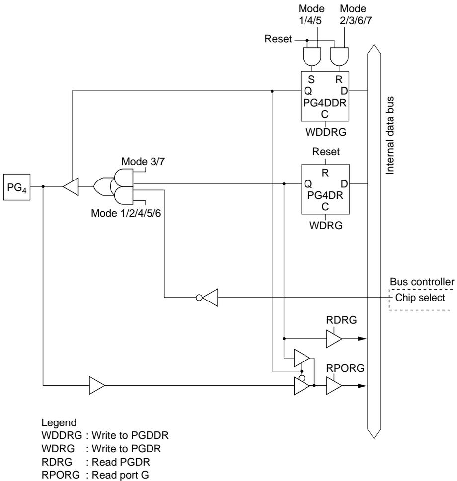
**Figure C-12 (d) Port G Block Diagram (Pin PG<sub>4</sub>)**
