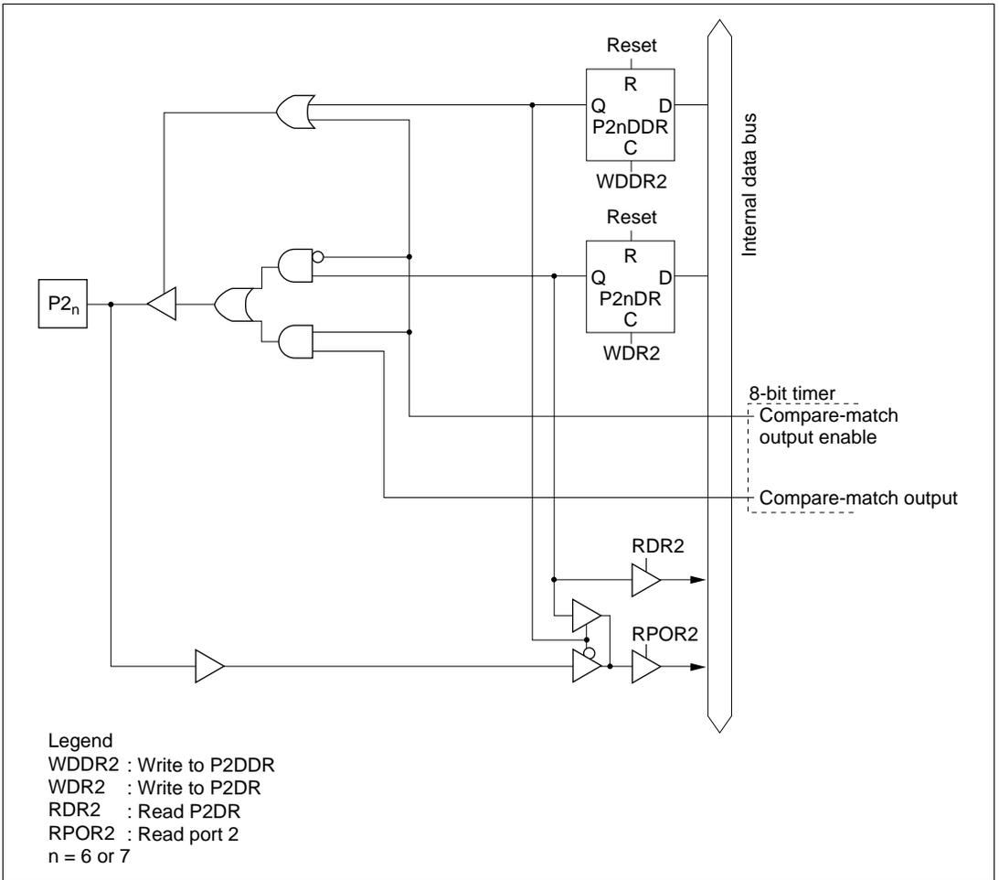
Figure C-2 (d) Port 2 Block Diagram (Pins  $P2_6$  and  $P2_7$ )
