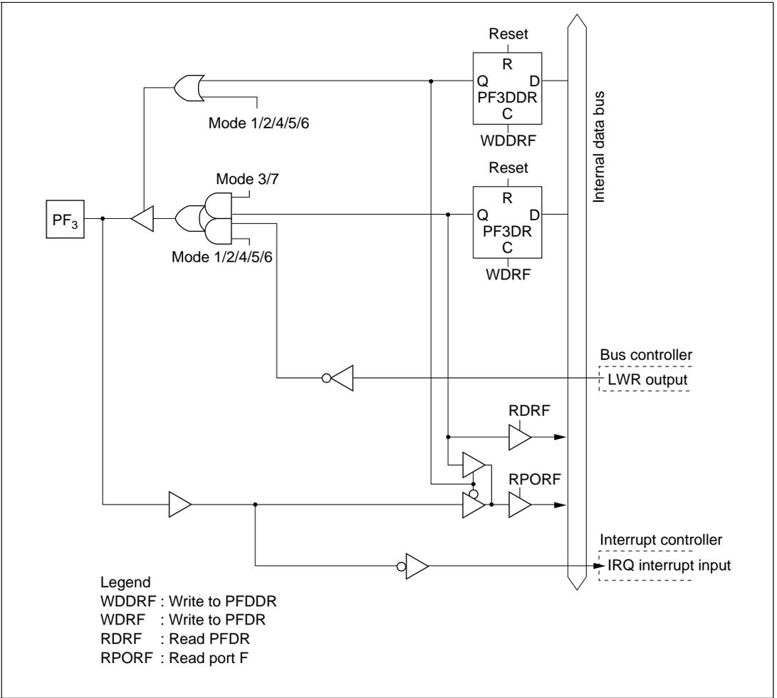
**Figure C-11 (d) Port F Block Diagram (Pin PF<sub>3</sub>)**
