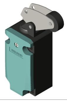
SIRIUS POSITION SWITCH METAL ENCLOSURE 40MM ACC. TO EN50041 DEVICE CONNECTION 1X (M20X1.5) 1NO/1NC SNAP-ACTION CONTACTS ANGULAR METAL ROLLER LEVER AND PLASTIC ROLLER 22MM
