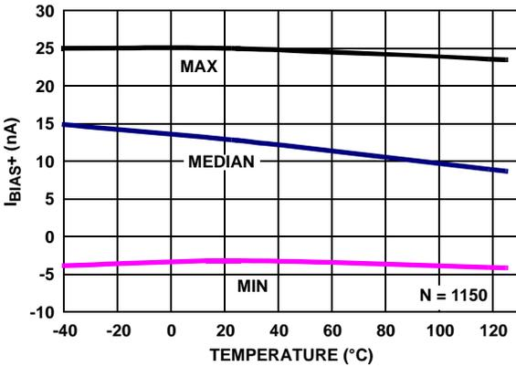
FIGURE 26.  $I_{BIAS+}$  vs TEMPERATURE,  $V_+$ ,  $V_- = \pm 2.5V$
