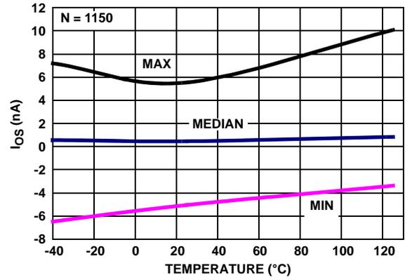
FIGURE 31.  $I_{OS}$  vs TEMPERATURE,  $V_+$ ,  $V_- = \pm 1.2V$
