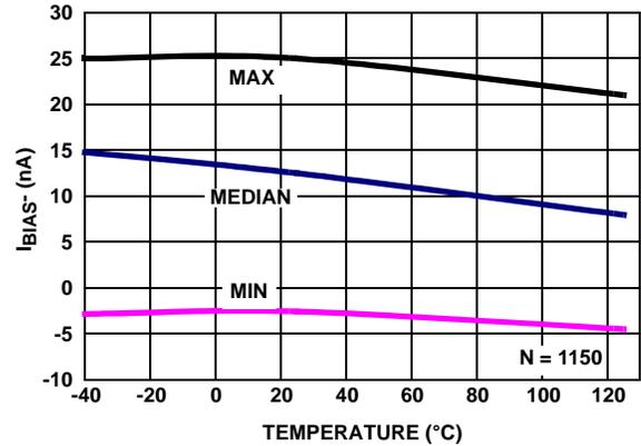
FIGURE 27.  $I_{BIAS-}$  vs TEMPERATURE,  $V_+$ ,  $V_- = \pm 2.5V$
