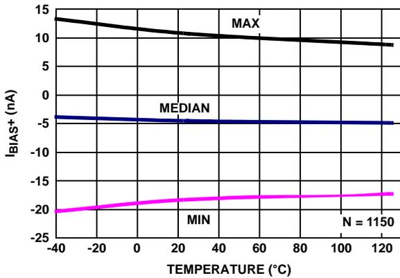
FIGURE 28.  $I_{BIAS+}$  vs TEMPERATURE,  $V_+$ ,  $V_- = \pm 1.2V$
