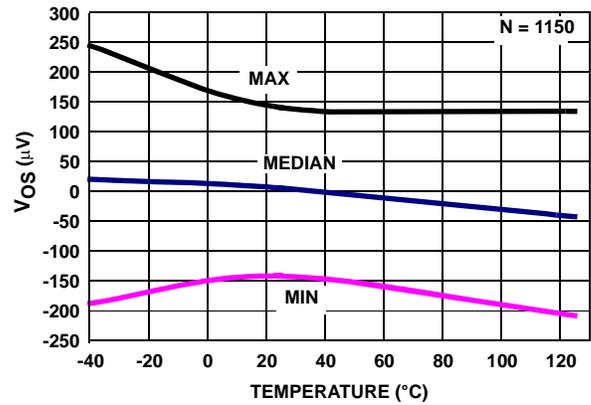
FIGURE 23.  $V_{OS}$  vs TEMPERATURE,  $V_+$ ,  $V_- = \pm 2.5V$ , SOIC PACKAGE
