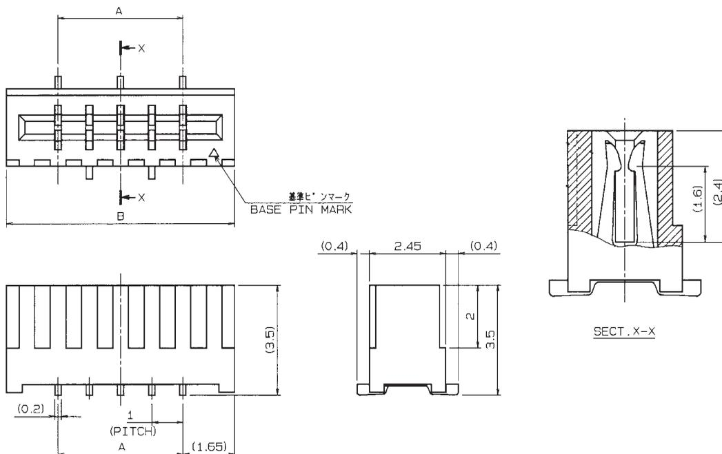
基板取付け寸法 (コネクタ搭載面側)
