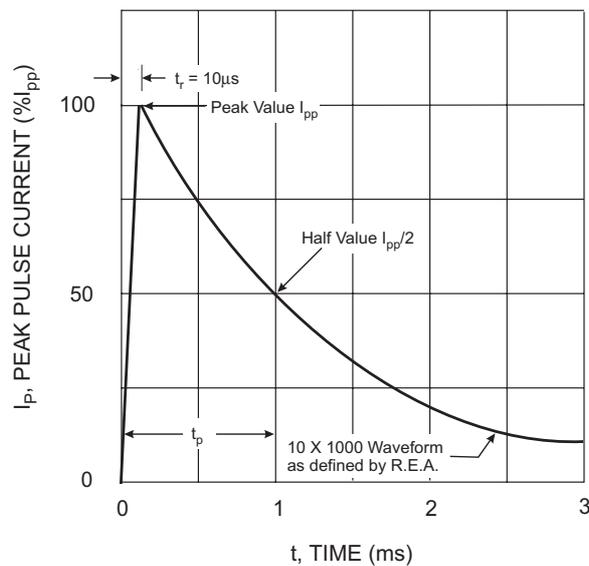
Fig. 4 Pulse Waveform
