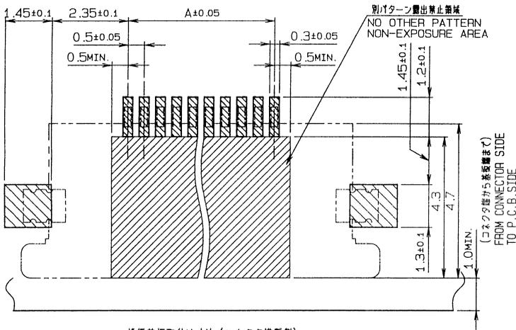
推奨基板取付け寸法 (コネクタ搭載側)
