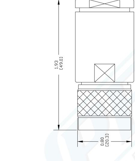
SLIDE BRAID CLAMP (4) OVER BRAID & SEAT AGAINST JACKET. PERMIT ASSEMBLY OF BRAID CLAMP (4)
