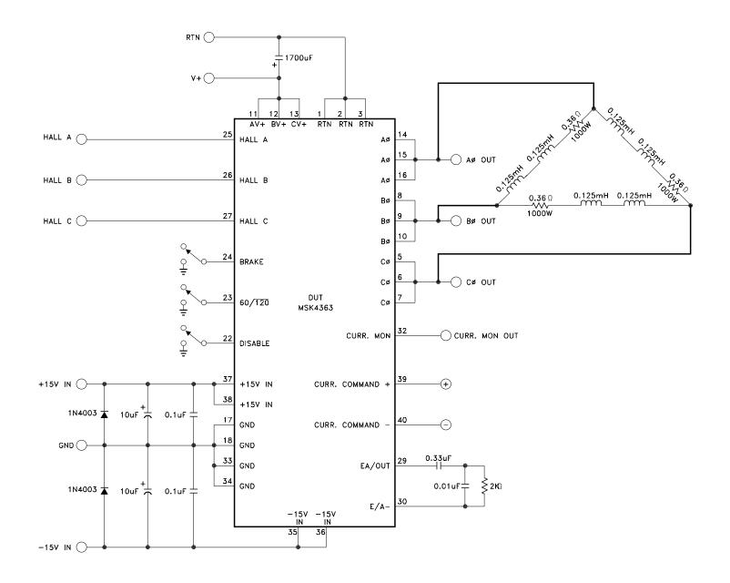
TYPICAL TEST SCHEMATIC
