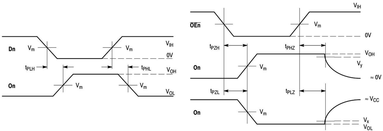
**WAVEFORM 3 – PROPAGATION DELAYS**
