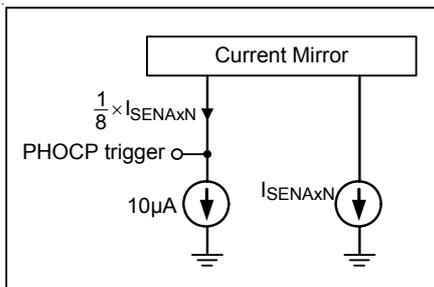
Figure 20. VDDNB Controller : Per-Phase OCP Setting
