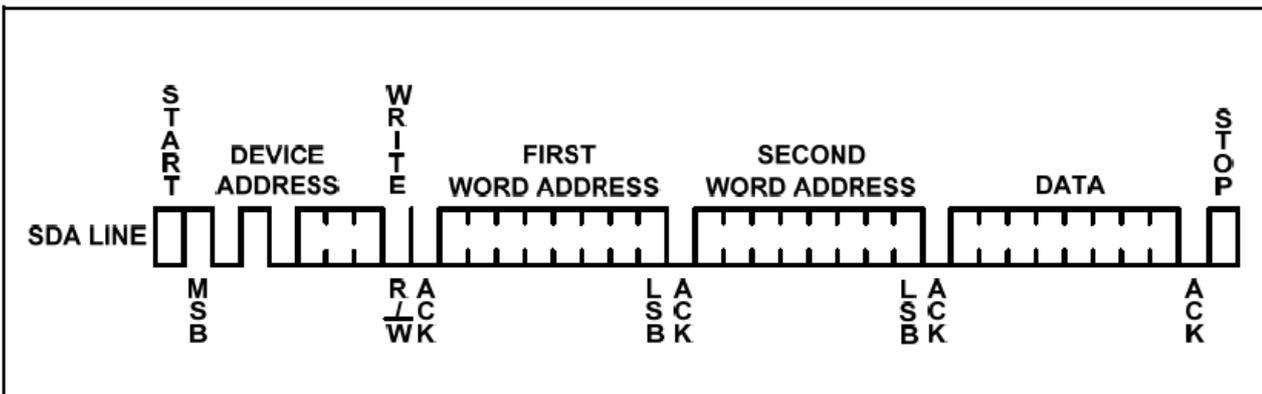
Figure 8 · Byte Write
