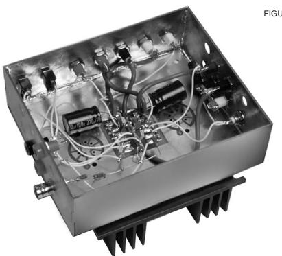
FIGURE 3. INSIDE OF ASSEMBLED BOX. HOLES FOR COMPONENTS ON LONG SIDE WERE USER DRILLED.
