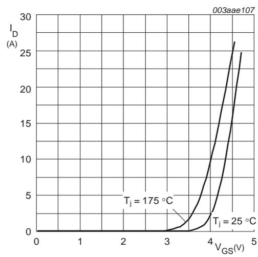
$T_j = 25\text{ °C}$ ;  $V_{DS} = 15\text{ V}$
