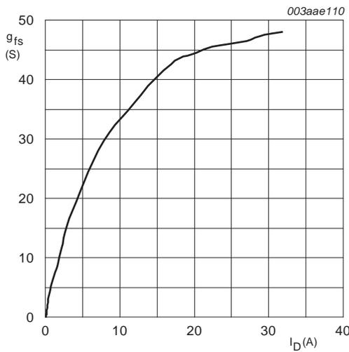
$T_j = 25\text{ °C}$ ;  $V_{DS} = 10\text{ V}$
