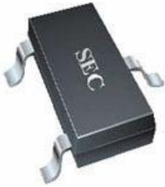
3 pin SOT23 (suffix SO)
