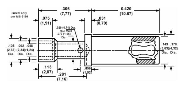
Min hole depth (socket) .333 (8,46)
