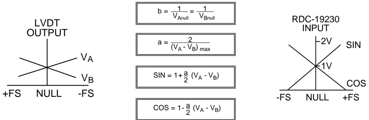
**FIGURE 25. 3-WIRE LVDT SCALING CIRCUIT**
