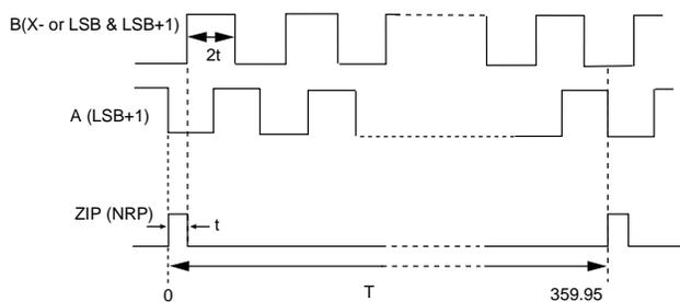
**FIGURE 22. INCREMENTAL ENCODER EMULATION**
