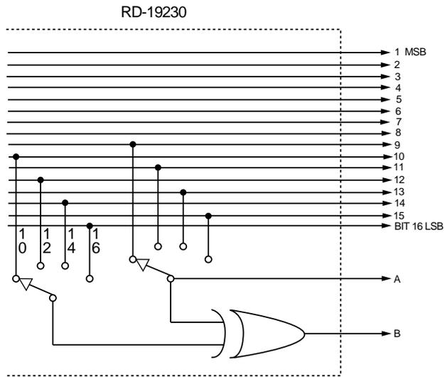
**FIGURE 21. INCREMENTAL ENCODER EMULATION RESOLUTION CONTROL**
