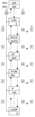
2. How to assign parameters (1) Calling parameters
