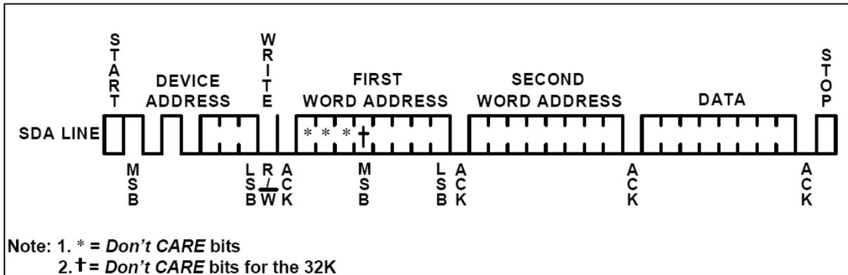
Figure 8 · Byte Write
