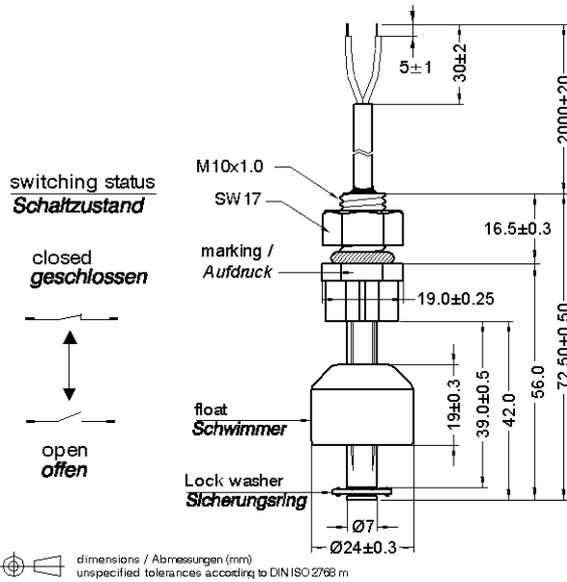
dimensions / Abmessungen (mm)
