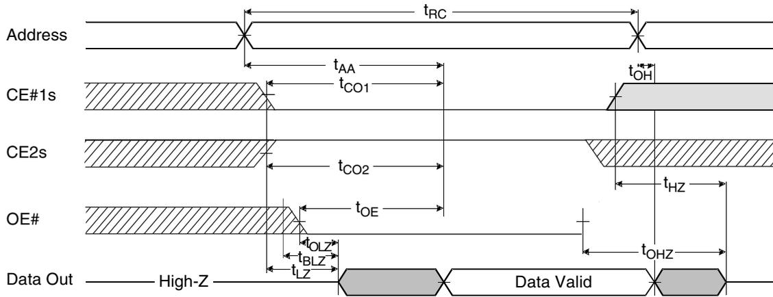
Figure 29. SRAM Read Cycle
