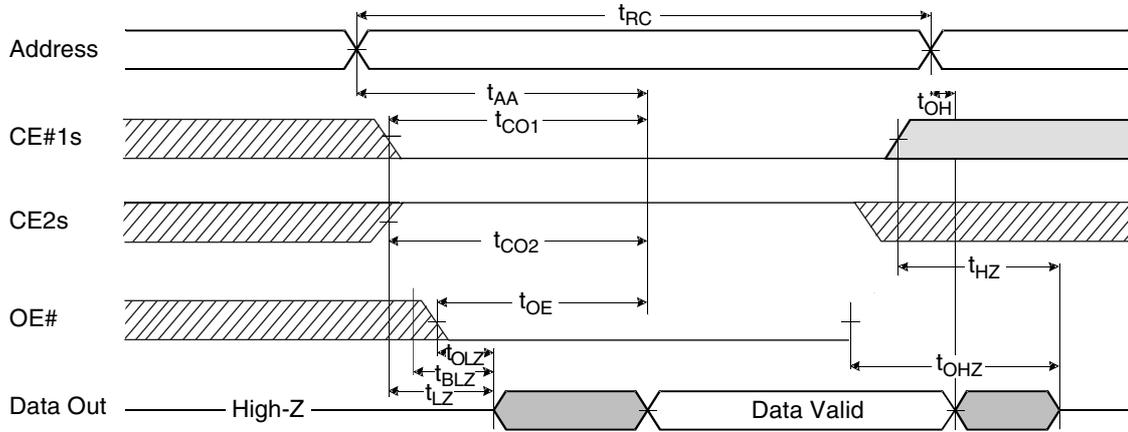
Figure 29. SRAM Read Cycle
