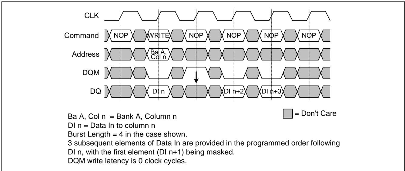
Figure 32 WRITE Burst - DQM Operation
