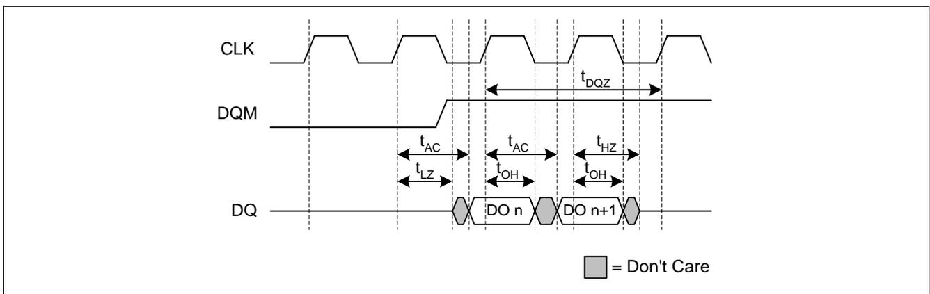
**Figure 12 Basic READ Timing Parameters for DQs**
