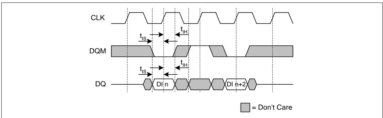
**Figure 24 Basic WRITE Timing Parameters for DQs**
