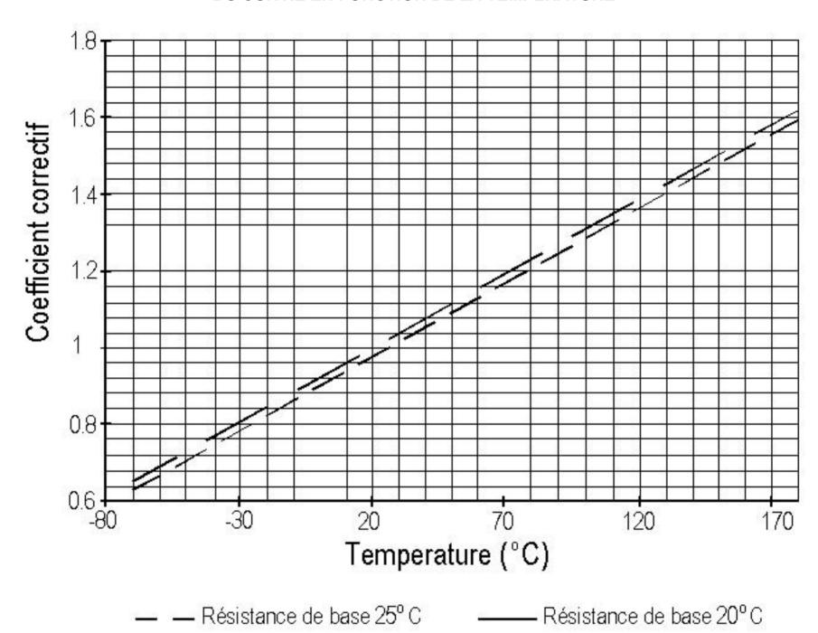
Exemple: Le catalogue donne une résistance à 25°C de 935 ohms. Quelle valeur à 125°C? Le coefficient correcteur sur l'abaque est de 1,39 à 125°C. R devient: 935x1.39=1299 Ohms
