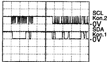
⑤ 5V/cm, 200 \mu s/cm 5V/cm, 200 \mu s/cm nur bei Prog.-Wechsel only on prog. change
