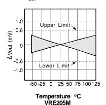
$V_{\text{OUT}}$  vs. TEMPERATURE
