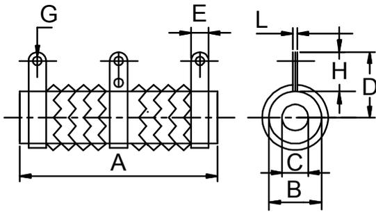
Ribbon-Wire Adjustable Resistors (DQS)
