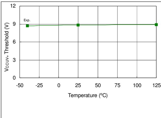
Fig. 30. V<sub>CCUV+</sub> Threshold vs. Temperature
