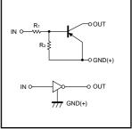
$R_1=4.7k\Omega / R_2=10k\Omega$
