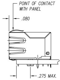
THE SUGGESTED PANEL OPENING IS INTENDED TO GIVE THE USER THE ABILITY TO HAVE REASONABLE JACK / PANEL CLEARANCES YET MAINTAIN RELIABLE GROUNDING CAPABILITY.
