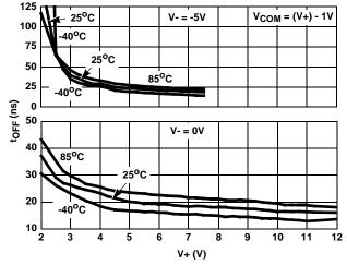
FIGURE 14. TURN - OFF TIME vs SUPPLY VOLTAGE
