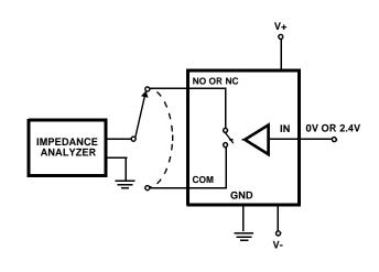
FIGURE 7. CAPACITANCE TEST CIRCUIT
