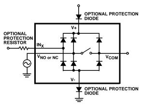
FIGURE 8. OVERVOLTAGE PROTECTION
