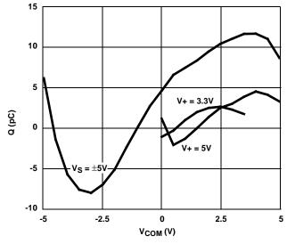
FIGURE 12. CHARGE INJECTION vs SWITCH VOLTAGE
