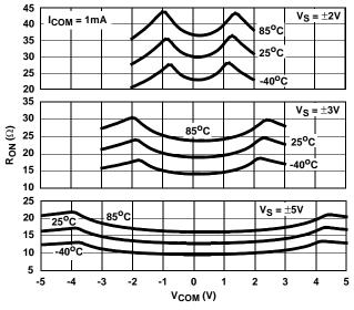
FIGURE 11. ON RESISTANCE vs SWITCH VOLTAGE
