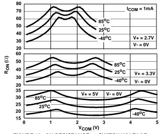
FIGURE 10. ON RESISTANCE vs SWITCH VOLTAGE
