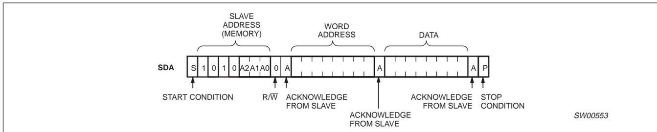
Figure 12. Byte write
