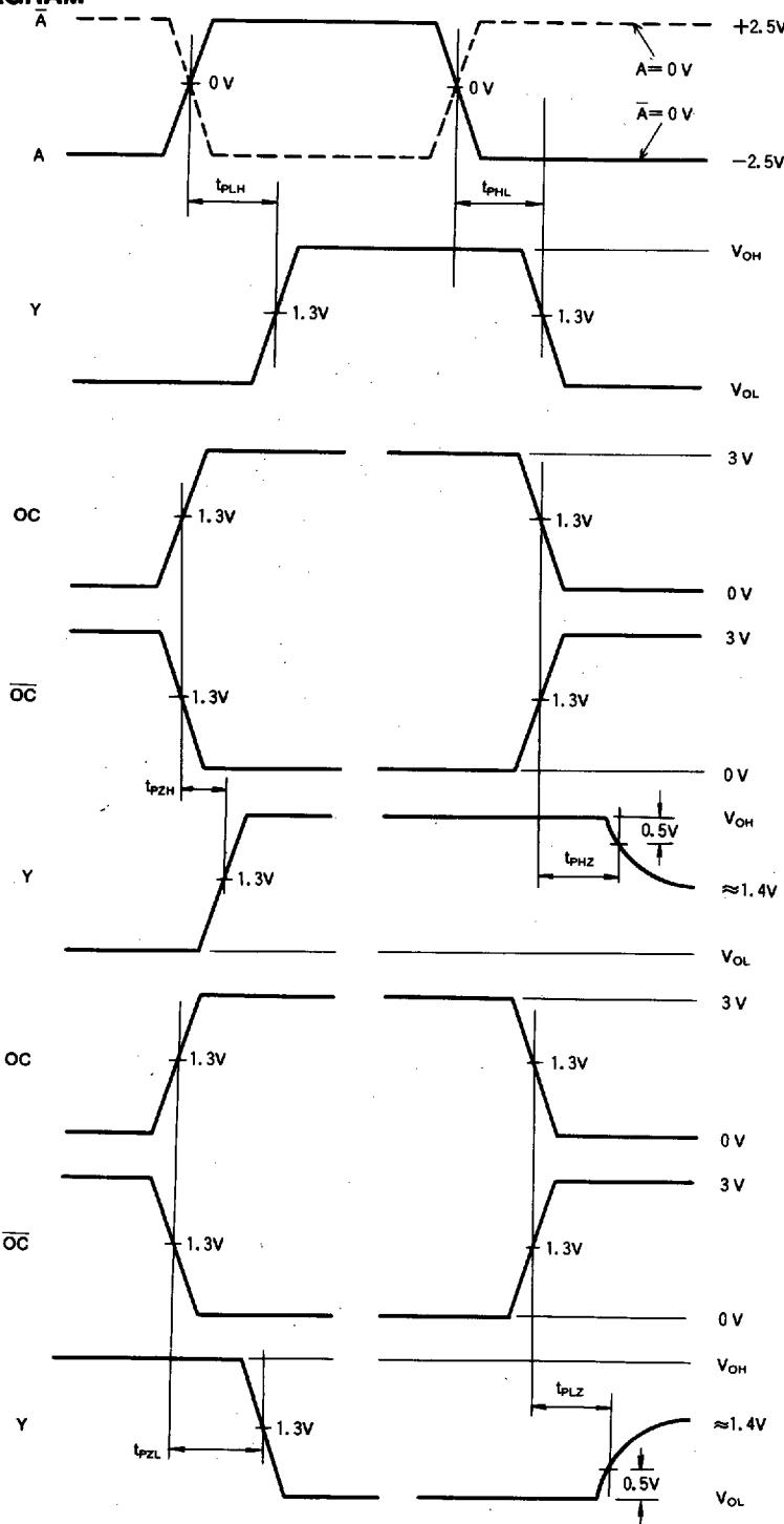
QUADRUPLE DIFFERENTIAL LINE RECEIVER
