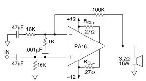
LOW INTERNAL LOSS MAXIMIZES EFFICIENCY
