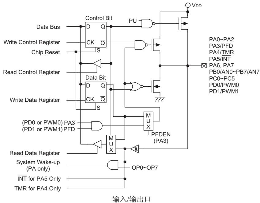
每个输入/输出口都有一个控制寄存器(PAC, PBC, PCC, PDC)，用来控制输入/输出状态。利用控制寄存器，可对 CMOS 输出、带或不带上拉电阻的斯密特触发输入通过软件动态地进行改变。做为输入时，对应的控制寄存器应设置为“1”。输入信号来源也取决于控制寄存器，如果控制寄存器的值为“1”，那么读取的是引脚状态；如控制寄存器的值为“0”，则读取的是内部锁存器的值。后者可能会在‘读-修改-写’指令中发生。
