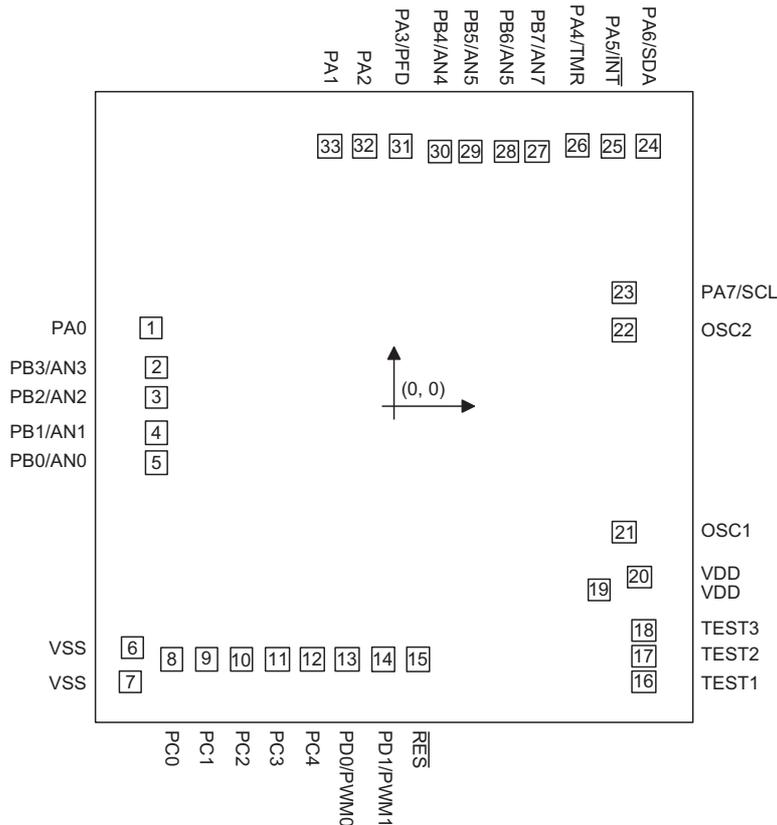
\*IC 的衬底要连接到 PCB 板上的 VSS
