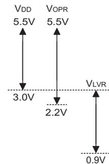
注:  $V_{OPR}$  是在系统时钟为 4MHz 时, 使得芯片正常运行的电压值
