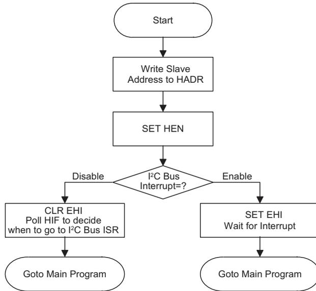
I<sup>2</sup>C 总线中断服务程序流程图
