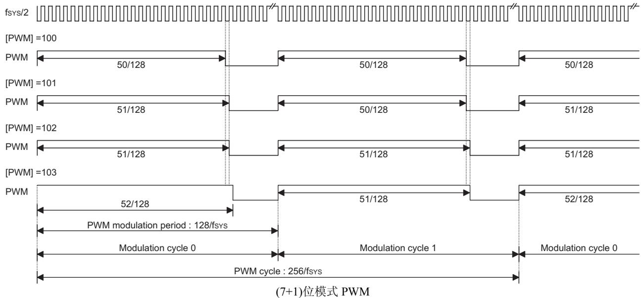
在(7+1)位 PWM 模式中，一个 PWM 周期被分为两个调制周期(调制周期 0~调制周期 1)，每个调制周期有 128 个 PWM 输入时钟。在(7+1)位 PWM 模式中，PWM 寄存器被分为 2 个部分。第一部分是直流分量，由 PWM.7~PWM.1 控制；第二部分是交流分量，由 PWM.0 控制。
