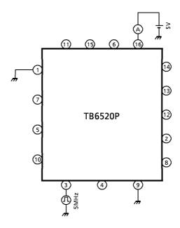
TEST CIRCUIT 2: I<sub>DD</sub> (opr.)
